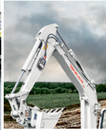
Schnelle Wechsel von Einsatzorten und hydraulischen Anbauwerkzeugen ermöglicht der Takeuchi TB 235 R mit seiner Taklock-Multikupplung.
