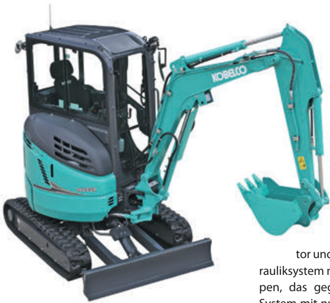
Reichlich Motor- und Hydraulikleistung sowie vollen Komfort in der Kabine bringt der Kobelco SK26SR-7 in der Klasse bis 2,6 t Betriebsgewicht.
