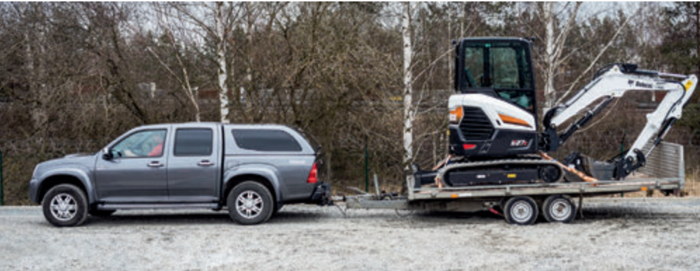
Auf maximale Mobilität getrimmte Minibagger wie der Bobcat E27Z werden für deutsche Kunden als Allzweckmaschinen für die Baustelle konzipiert.
