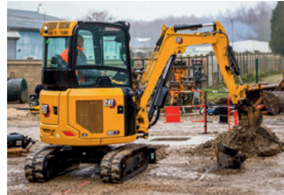
Minibagger sind universelle Geräteträger – hier der Cat 302.7CR mit Schnellwechsler für den einfachen Werkzeugwechsel.
