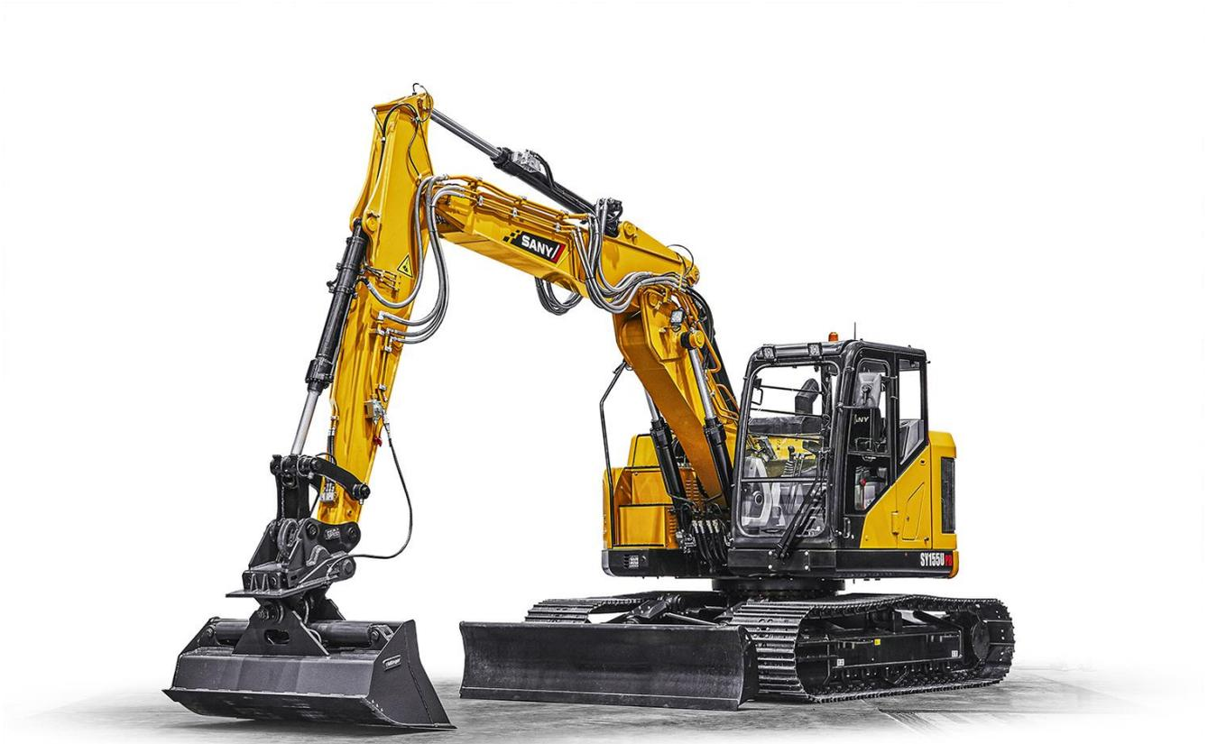
**Image 2:** *Mise à jour SANY SY155U – avec flèche en 2 parties et divers réglages de confort*
